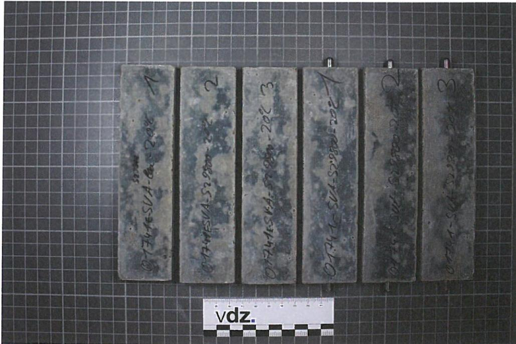
Bild 5: Probekörper aus CEM III/A 52,5 N-SR/LA "Duisburg" mit Hüttensand 2 (S2) nach 180 Tagen; Lagerung: 20 °C in Na<sub>2</sub>O<sub>4</sub>-Lösung
