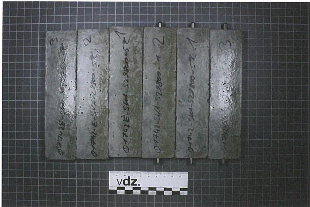
Bild 6: Probekörper aus CEM III/A 52,5 N-SR/LA "Duisburg" mit Hüttensand 2 (S2) nach 180 Tagen; Lagerung: 5 °C in Na<sub>2</sub>O<sub>4</sub>-Lösung
